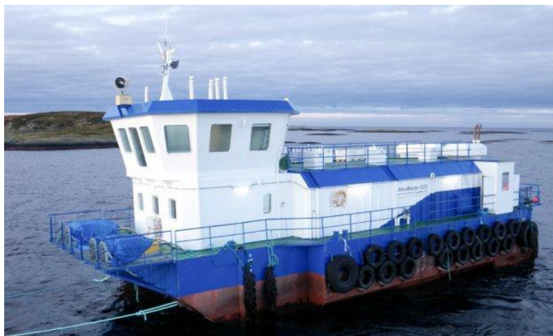
Mynd 6. Dæmigerður fóðurprammi, með stjórnstöð og starfsmannaaðstöðu. Fyrirhugað er að staðsetja slíkan pramma innan eldissvæðis, við kvíapýrpingu. Frá fóðurpramma er fóðrinu dælt út í eldiskvíar með háþrýstlofti gegnum plaströr.
